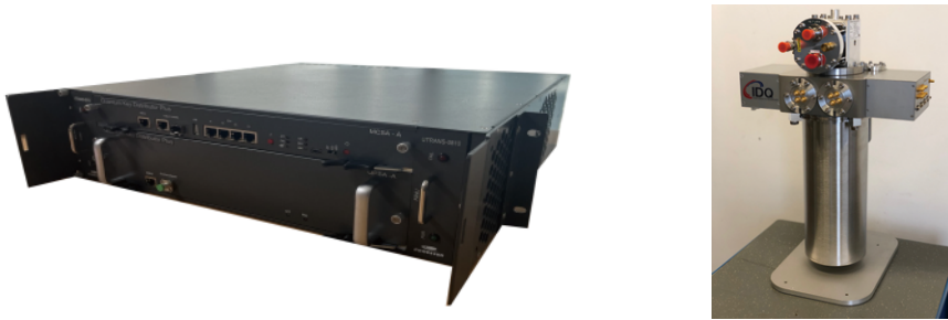
< (좌) QKD 장비(코워버, KT), (우) QKD 및 양자통신 활용 가능한 초전도 나노와이어 단일광자 검출기(IDQ) >
