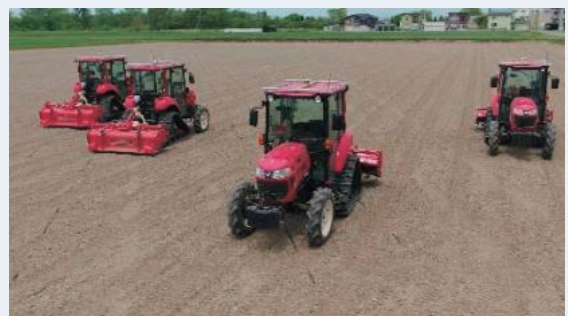
■第1-3-4図／ロボット農機（ロボットトラクタ）による実証試験（岩見沢市）
