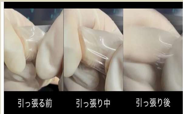
頑丈な超分子プラスチック 厚さ0.07mm、幅1cmの薄膜を引っ張っても、簡単に引き裂かれない様子が分かる。
