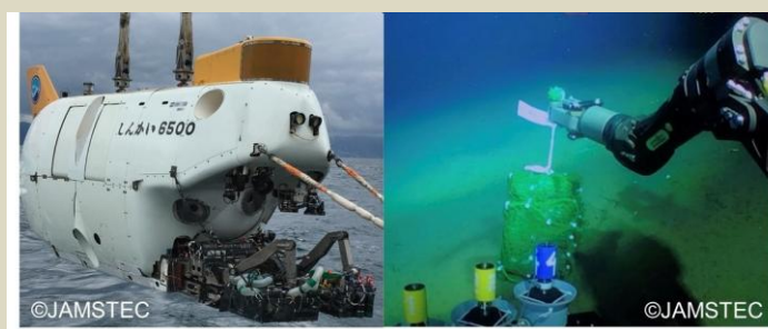
有人潜水調査船「しんかい6500」（左）により生分解性プラスチックを深海底に設置している様子（右）
